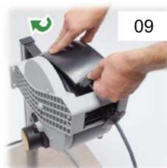
08 Guidare il cavo all'interno del MTPReel-O™ e chiudere con i carter di protezione !
